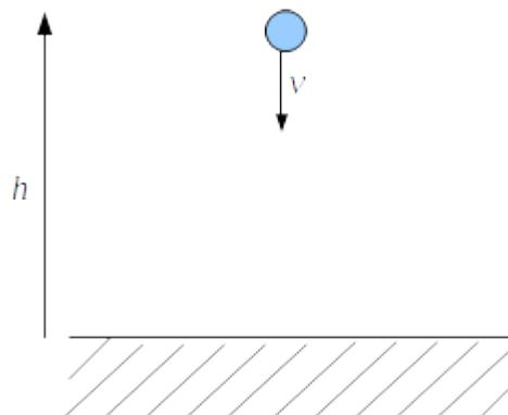
El objetivo es simular la altura ( $h$ ) de un objeto en caída libre. El objeto está suspendido en el aire con  $v=0$ , y su velocidad ( $v$ ) hacia la Tierra se incrementa con la aceleración correspondiente a la gravedad ( $G=9.8m/s^2$ ). Al altura del objeto queda especificada por las siguientes ecuaciones:
